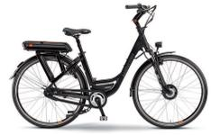
Beim Vorderradantrieb ist der Elektromotor in der Nabe des Vorderrads untergebracht. Technisch gesehen ist der Vorderradantrieb am leichtesten einzubauen und ist mit jeder Schaltungsvariante einschließlich der Rücktrittvarianten kompatibel. Daher sind günstige Pedelecs häufig mit einem Frontnabenmotor ausgerüstet. Bitte beachten Sie dass die Vorderradbeschleunigung als etwas gewöhnungsbedürftig gilt.
