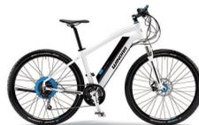
Bei dieser Antriebsform handelt es sich um einen Nabenmotor, der in die Hinterradnabe integriert ist. Beim Hinterradantrieb ist der größte Teil des Gewichts auf das Hinterrad verlagert was bei sportlicher Fahrweise gerade am Berg sowie bei Nässe von Vorteil ist. Der Hinterradausbau ist durch die benötigte Verkabelung für die Steuerung und den Motor um einiges aufwendiger als bei den anderen Varianten. Im Moment werden Pedelec mit Hinterradmotor nur als Kettenschaltungsvariante angeboten.
